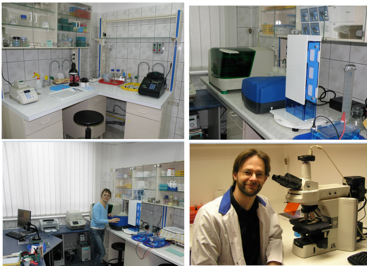
Rys. 2. Przykładowe laboratoria Katedry Genetyki UWM, którą organizowałem od podstaw i kierowałem w latach 1998-2013. Laboratoria są wyposażone w termocyklery z gradientem temperaturowym oraz z możliwością podłączenia bloku do hybrydacji in situ (lewa góra), stanowisko do mikromacierzy – drukarka i skaner (prawa góra), stanowisko dla PCR w czasie rzeczywistym (lewa dół, na wprost) oraz pracownia cytogenetyczna z mikroskopem fluorescencyjnym. Laboratoria miały łączną powierzchnię około 200 m 2 i umożliwiały pracę w warunkach sterylnych z wykorzystaniem pełnego spektrum metod molekularnych.
